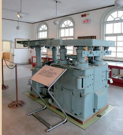
石炭採掘現場で、作業員保護のため天井が落ちないように支えた自走枠
