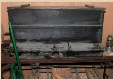
炭鉱鍛冶に刀鍛冶の特長を加えて作られた輪。パッキン代わりに狸の毛が使われている
