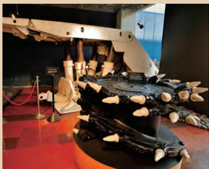
池島炭鉱で使われていた石炭採掘用の掘進機ロードヘッド
