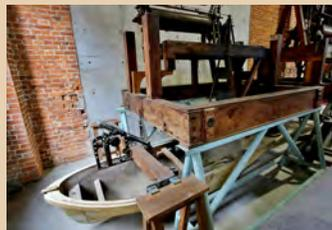
わが国初の船型試験場・砲の浦水槽で使用していた抵抗動力計(1907~1958)
